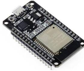
**Gambar 2. 1** Mikrokontroler ESP32
