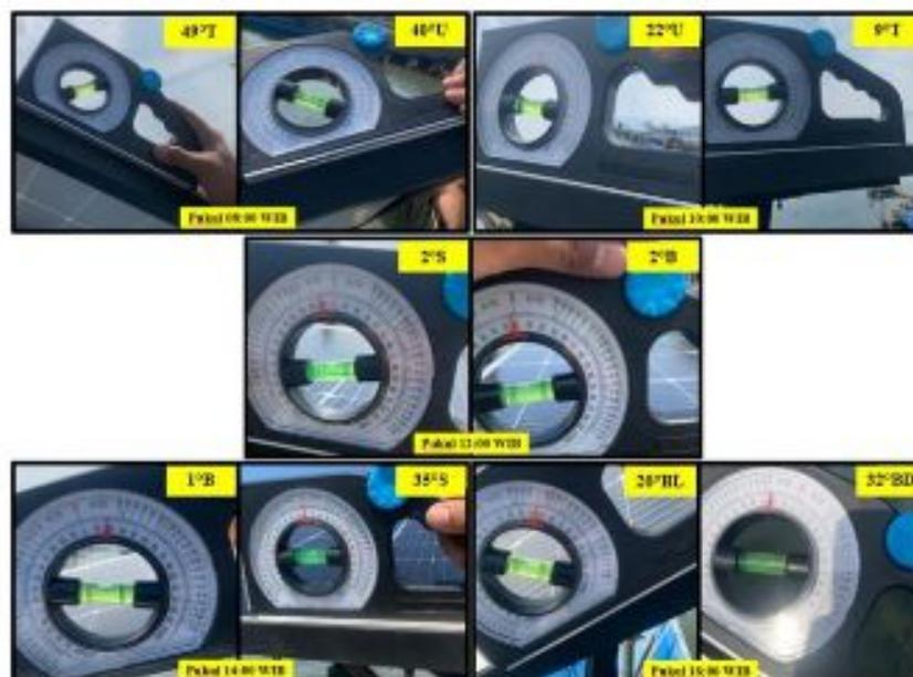
**Gambar 4.4** Sudut kemiringan dari 5 kali pengujian pada hari ke-2
