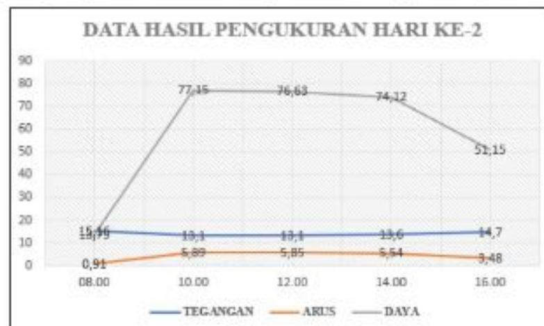
**Gambar 4.5** Data Hasil Keluaran Panel Surya *Dual axis* Hari Ke-2
