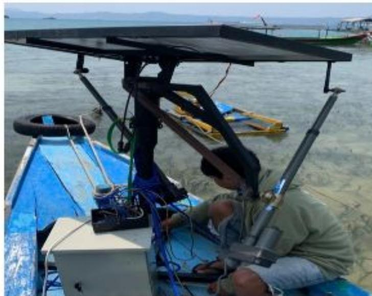
**Gambar 4.1** pemasangan dan kalibrasi panel surya *dual axis* pada perahu nelayan
