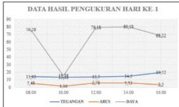
**Gambar 4.3** Data Hasil Keluaran Panel Surya *Dual axis* Hari Ke-1
