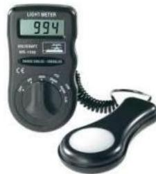
**Gambar 2.9** Alat ukur intensitas cahaya *lux* meter
