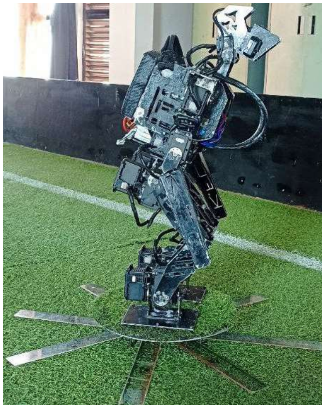
Gambar 4.3 Proses Kalibrasi Kompas
