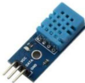
**Gambar 2. 14** Sensor DHT11
