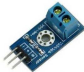
**Gambar 2. 16** Sensor Tegangan
