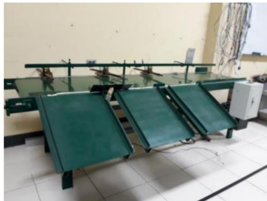
Gambar 2.1. Konveyor dan jalur distribusi
