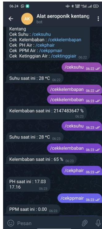
Gambar 2.17 Tampilan Data Sensor Pada Telegram
