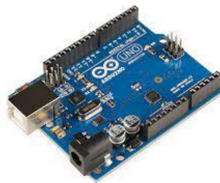
Gambar 2.13 Arduino Uno R3 Sumber : (Dani, 2018)
