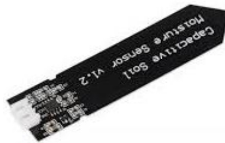
Gambar 2.5 Sensor Soil Moisture Sumber : (Galih Mardika, 2019)
