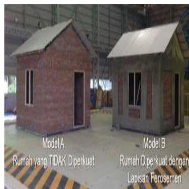
Gambar 2.6. Rumah Model A dan B sebelum dilakukan percobaan meja getar.
