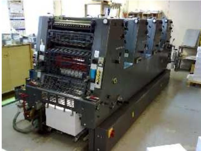
Gambar 3.1 Mesin Percetakan Besar GTO
